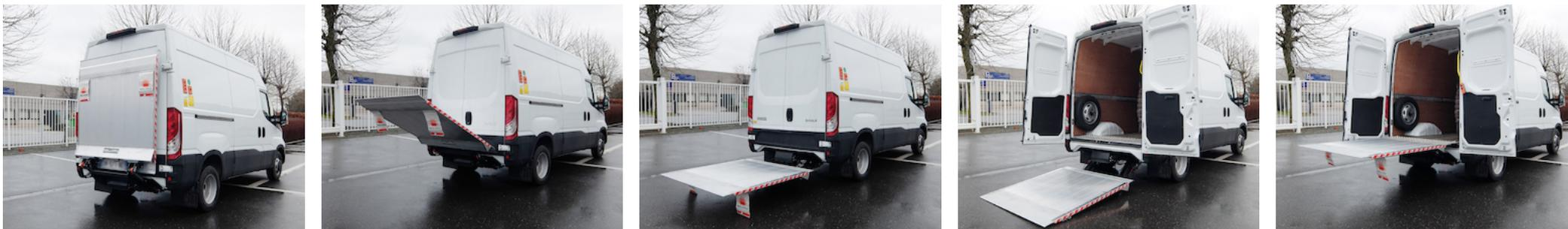
**Option OWU004 = exécution hayon TAXI.** Elévateur de personnes (TPMR) avec plateforme en acier déployé, arrêt de roll automatique et commandes d'urgence. La commande aux pieds et les rambarde de sécurité sont disponible en option.
