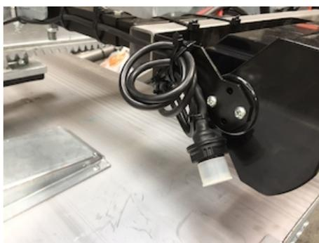
OAE500 - Connexion VEHH par prise pour interrupteur de cabine
