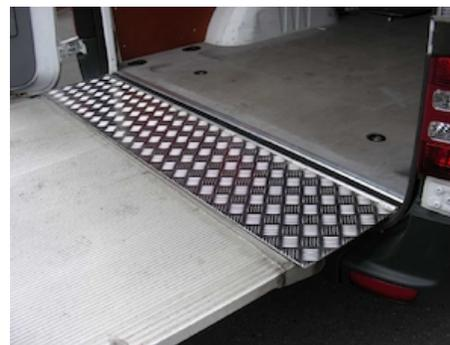
OAM008 - Rampe de passage entre le plancher et la plateforme
