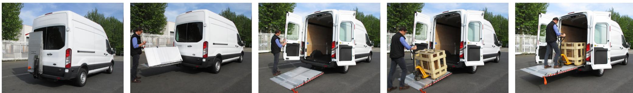
**Option OAT200 = kit de carrosserie qui remplace les portes arrière du véhicule**, conçu pour les modèles H2 de la plupart des modèles de fourgon d'origine. Cette option offre une surface de plateforme accrue, et simplifie les opérations d'ouverture et fermeture du hayon.
