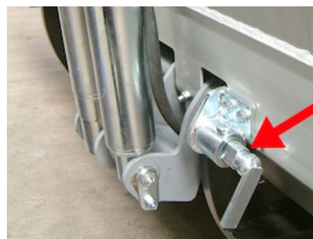
OAP432 - Verrouillage mécanique de plateforme pour DH-LSP
