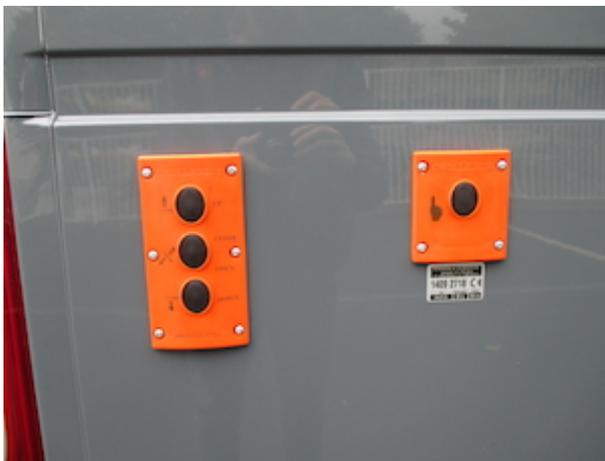
Commande extérieure 3+1 boutons, adaptée pour montage dans la paroi de la carrosserie [OAE031.Z]
