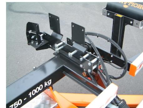
OAM014 - Plaques de montage rapide par type de véhicule
