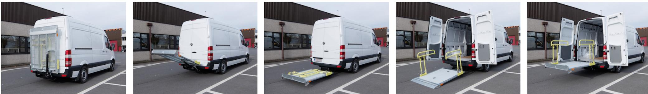
**DH-LSP(Z) élévateur pour ambulance.** Solutions flexibles adaptées aux exigences du client, p.ex. avec rambarde de sécurité, arrêts de roll automatiques et commande d'urgence.
