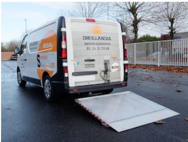
Plateforme légère en aluminium avec surface antidérapante
