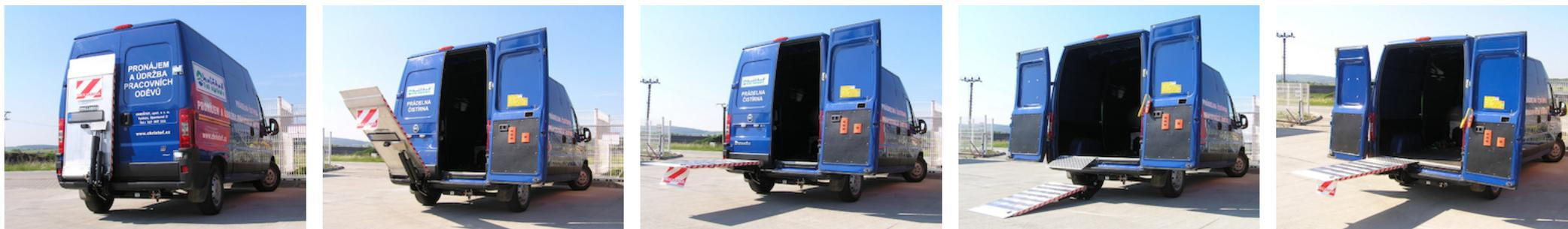
**DH-LSPZ + option OAP406 = plateforme pliable.** Offre un accès libre à l'espace de chargement, mais peut être déployée pour former une plateforme de largeur intégrale en quelques secondes.
