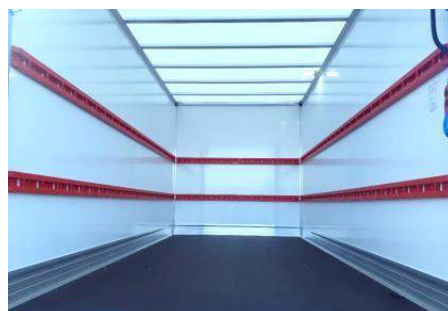
Aménagement Mixte 2 niveaux de capotons composite allégés 2 en 1
