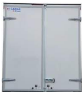
Fermeture par 2 portes arrière battantes version simple
