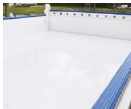
Fond de benne en tôle acier HLE galvanisé Épaisseur 2,5 mm
