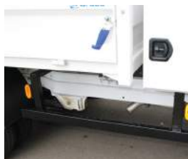
Protection latérale robuste pouvant servir de marchepied Feux latéraux (option)
