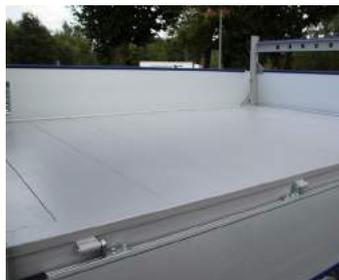
Fond de benne autoporteur en profils aluminium.
